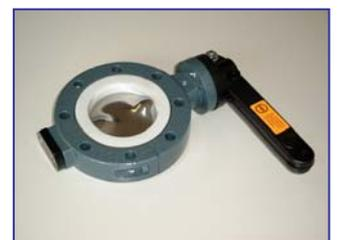
Absperrklappen mit 2-teiliger Achse, mit Griff, Edelstahlachsen (V4A), Edelstahlsteller (V4A), elastischer Dichteinlage aus EPDM, PTFE ummantelt. Ringkörper aus Leichtmetall. Betriebsdruck: 6 bar. Temperaturbeständigkeit bis +130 °C.
