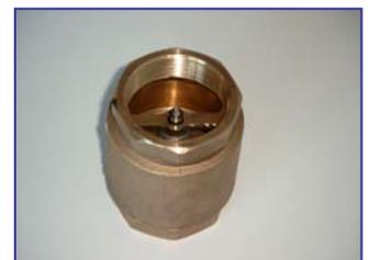
Disco-Rückschlagventil in Zwischenflanschbauweise. Gehäuse aus Messing. Ventilplatte, Bügel, Feder und Sprengring aus nichtrostendem Stahl. PN 10/16. Typ „Gestra“ RK 41.
