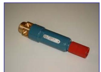
**Normal-Sicherheitsventil mit Viton-Dichtung. F/K/S geprüft, mit Überströmhaube und CE-Kennzeichnung. Einsetzbar bis: bis 180°C.**
