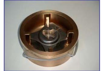
Disco-Rückschlagventil in Zwischenflanschbauweise. Gehäuse aus nichtrostendem Stahl. Ventilplatte, Bügel, Feder und Sprengring aus nichtrostendem Stahl. PN 10 - 40. Typ „Gestra“ RK 86.
