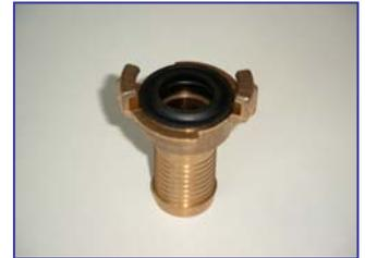
**Geka-Schlauchkupplung mit Verschraubung.** Schnelles und leichtes Kuppeln: Schraubringe zurückschrauben, kuppeln, Schraubringe anziehen.
