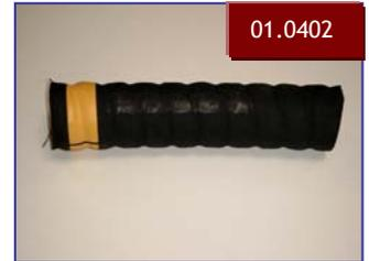
**Universal-Chemieschlauch mit Stahlspirale für viele Chemieprodukte, polare Lösungsmittel wie Säuren, Laugen, Salze, Ester, Ketone, Phenol, techn. Alkohole, Heißwasser geeignet.** Hochflexibel, innen glatt. Kennzeichnung: blau/weiß. Rollenlänge: 40 m.
