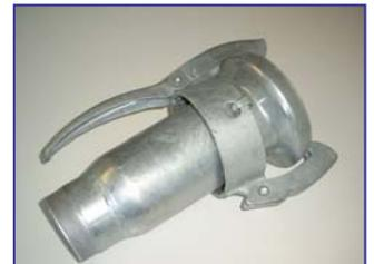
Kardan-M-Teil mit Außengewinde aus VA und weißer Dichtung. Werkstoff: 1.4571 mit verzinktem Hebelwerk.
