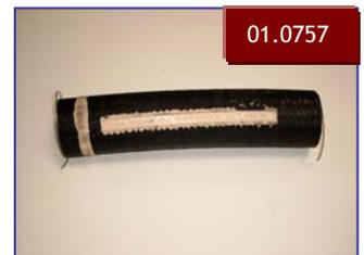
**Saug- und Drucktankwagenschlauch mit Stahlspirale für Mineralölprodukte** mit einem max. Aromatengehalt von 60%. **Hochflexible Ausführung** (Entsprechend TRbF 131/T2 und EN 122/5). Temperaturbeständig von - 25°C bis + 80°C. Rollenlänge: 40 m.
