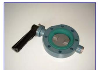
Absperrklappen mit 2-teiliger Achse, Standardausführung mit Griff, Edelstahlachsen (V2A), Edelstahlteller (V2A) poliert und elastischer heller Perbunan-Dichteinlage. Ringkörper aus Leichtmetall. Betriebsdruck: 6 bar.
