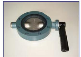
**Absperrklappen mit 2-teiliger Achse, Standardausführung mit Griff, Edelstahlachsen (V2A), Stahlteller (C35) und elastischer Vulkollan-Dichteinlage für abrasive Medien. Ringkörper aus Leichtmetall. Betriebsdruck: 6 bar.**
