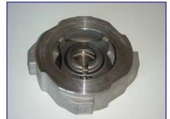
Disco-Rückschlagventil in Zwischenflanschbauweise. Gehäuse aus Edelstahl. Ventilplatte, Bügel, Feder und Sprengring aus nichtrostendem Stahl. PN 10 - 40. Typ „Gestra“ RK 66.
