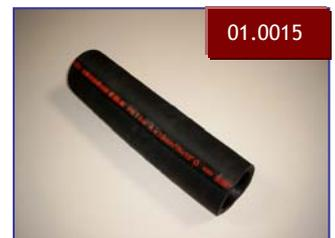
**Saug-, und Druckförderschlauch mit Stahldrahtspirale und Kupferlitze** für Zement, Kalk usw. .Temperaturbeständig bis +80°C. Rollenlänge: 40 m.
