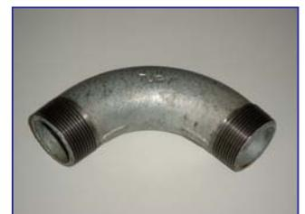
Nahtloser Stahlrohr-Schweißbogen 90° (Siederohrbogen), Werkstoff ST 37, Norm 3 S mit beiderseits angeschweißtem R 3" Außengewinde.
