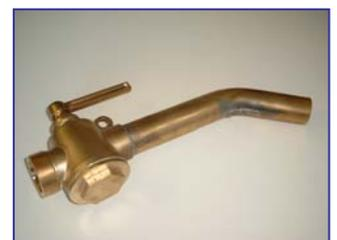
**Vollschlauch-Zapfventile, Typ ZH.** Werkstoffe: Gehäuse Alu, Kugel Alu, hart-coatiert, Innenteil MS. Dichtungen Viton, PTFE, Vulkollan und NBR.
