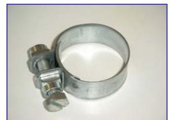
Patent-Schellen, zweiteilig, mit Spannbackenanzug in rostgeschützter Stahlausführung mit zwei Schrauben M 8 bzw. M 10.
