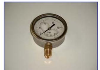
**Glyzerin-Manometer, VA-Gehäuse, Gehäusedurchmesser: 63 mm, Anschluß: MS-Rohrstutzen 10 mm Durchmesser.**
