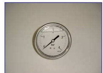
**Glyzerin-Manometer, VA-Gehäuse, Gehäusedurchmesser 100 mm, MS-Anschluß R ½“ AG.**
