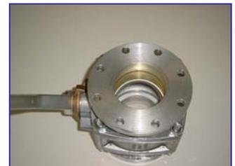
**Leichtmetall-Kugelhahn mit einerseits Flanschanschluß andererseits Außengewinde und Edelstahl-Kugel. Nenndruck 10 bar (PN10).**
