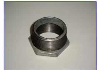
Verzinkter reduzierter Temperguß-Doppelnippel Nr. 245, Außengewinde x Außengewinde.
