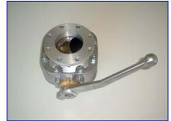
**Leichtmetall-Kugelhahn mit beiderseits Flanschanschluß. Nenndruck 10 bar (PN10). Nur für Mineralölprodukte. Kugel aus Leichtmetall, eloxiert.**
